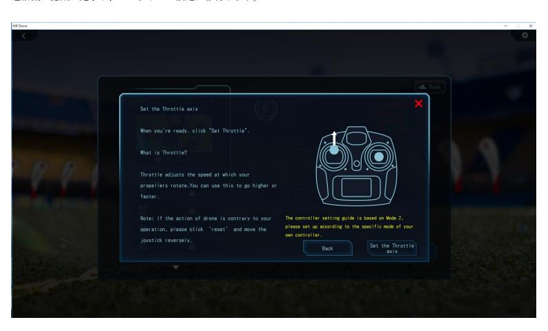
Set the Throttle axix ボタンを押し、スロットル操作を行うスティックを上に入れると設定完了です。
