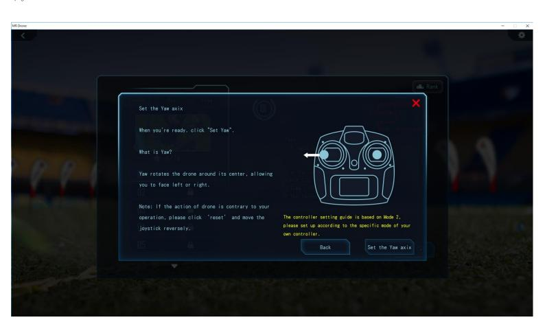
スロットルと同じように Set the Yaw axix ボタンを押し、ヨー操作を行うスティックを左に入れます。
