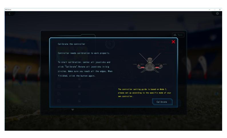
送信機と PC をドングルで接続して送信機の電源を入れ、スティックをセンターに合わせた状態で Calibrate ボタンを押し、両スティックを上下左右の端まで通るように操作すると 送信機の認識が完了し、スロットルの設定に移行します。
